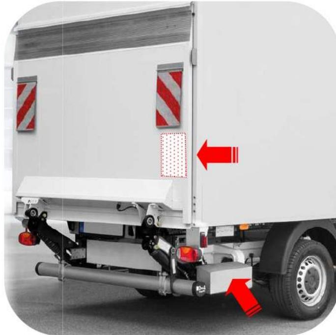
Positionnez l'étrier de serrage de la goupille de verrouillage contre le cadre pour définir la position du trou sur le côté (en utilisant comme gabarit).
