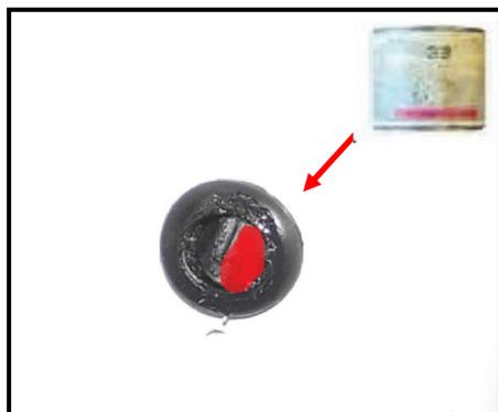
Puis fermer la porte, actionner la serrure : l'empreinte est réalisée. Percer Ø11 au centre de l'empreinte.\*
