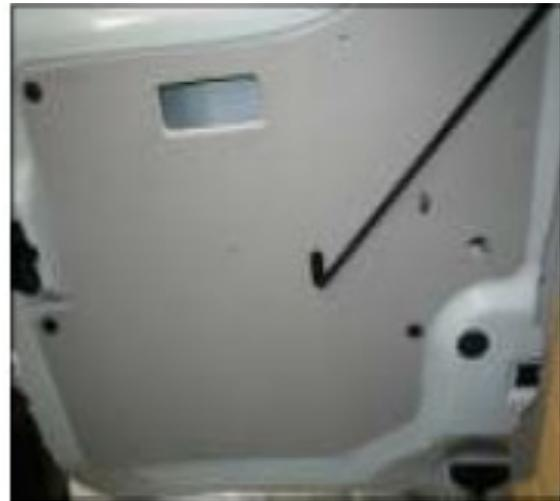
Partie haute : Placer le guide tringle en **buté sur le brossage** de la carrosserie.
