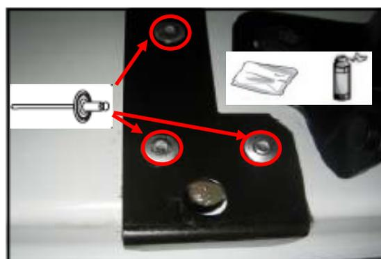
**\* Percer la première épaisseur de la carrosserie haute du véhicule. Placer et fixer la gâche haute à l'aide des trois rivets pop.**
