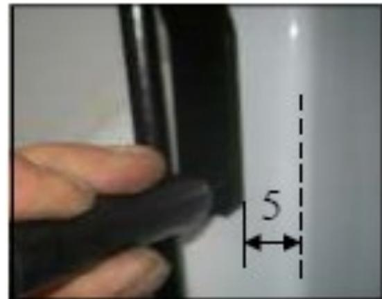
Partie haute : Tracer puis percer Ø9 l'emplacement du trou de fixation de la face avant, placer un insert
