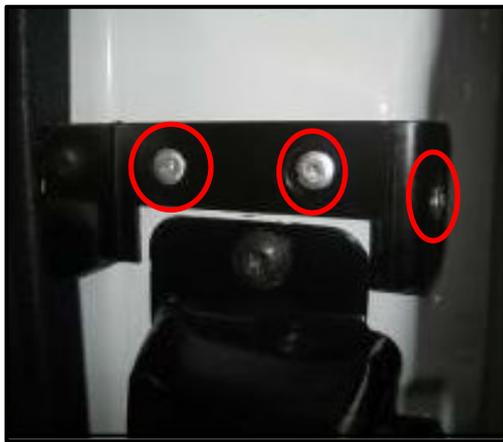
Percer  $\varnothing 11$  dans l'axe du rond de la fermeture basse d'origine le plus près possible de l'extérieur de la porte.
