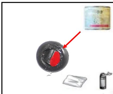
Puis fermer la porte, actionner la serrure : l'empreinte est réalisée. Percer  $\varnothing 11$  au centre de l'empreinte.
