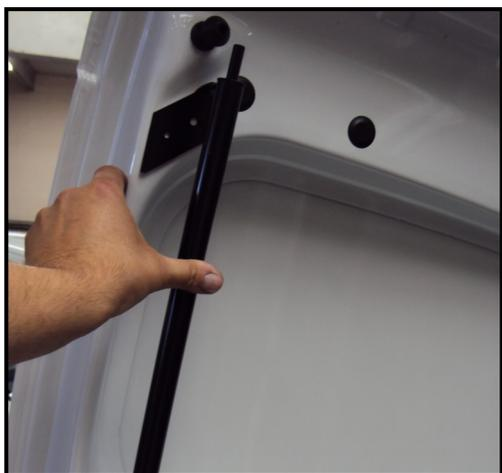
Après avoir retiré le guide tringle, percer les 2 trous Ø9 et placer les inserts M6.
