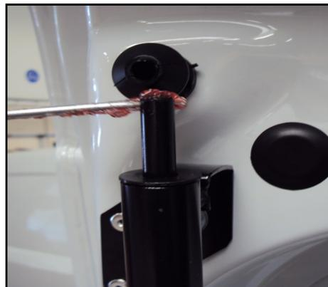
Fermer les portes du véhicule puis actionner la clé, cela laissera une empreinte sur la gâche haute.
