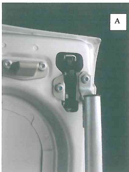
passer la partie haute de la tringle dans le guide et la visser a la partie basse
