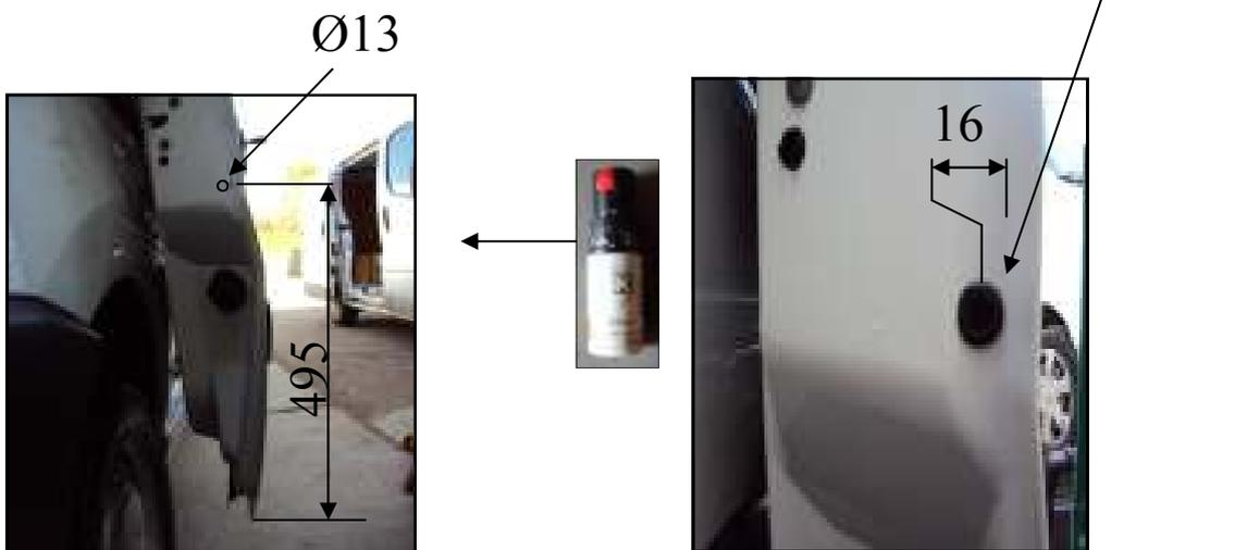
Mettre en place la tringle latérale puis ajouter de la graisse sur le bout de celle-ci ,refermer la porte et actionner la clé.
