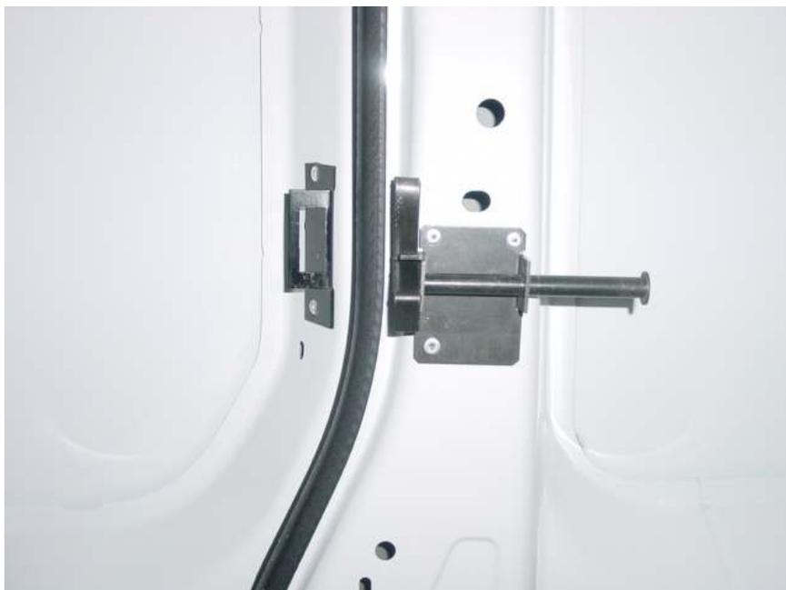
Positionner le support de targette sur le montant du véhicule
