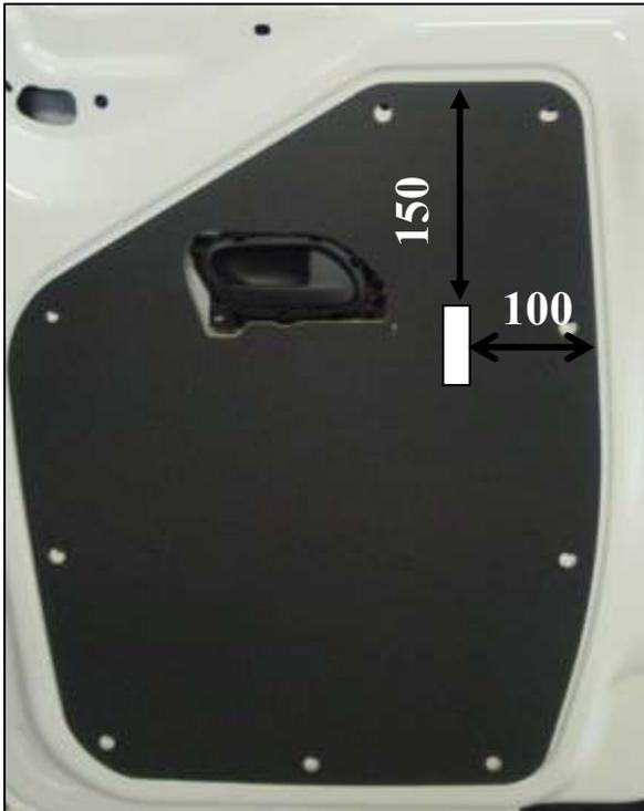
Fenêtre d'ouverture passage de tringle
