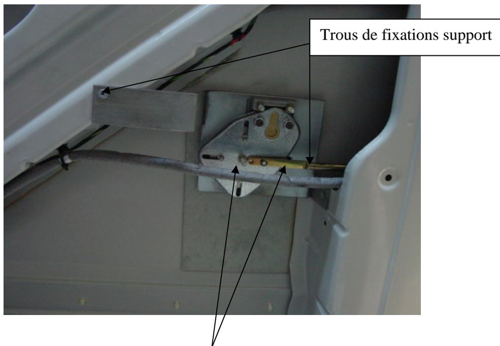
Percer les 2 trous de fixation du gabarit de perçage du passage de serrure avec un foret de 7
